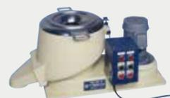
通过筛网高速地旋转产生的离心力作用，能去除巧克力内的异物。内置低温电气加热器，可间接保温巧克力。
