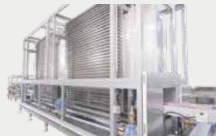
用于成型线的立体冷却隧道。节省空间的同时实现了最高效的冷却能力。可存储的模板数量从100到600张不等。
