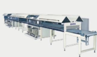
用于连接在涂层机和成型机后面的传送带式冷却隧道。在冷却隧道中形成的理想温度曲线可生产出巧克力富有光泽口感美味。隔热盖易于打开和关闭，方便清洁和维护。
