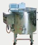
融油缸的内部和外部都是由不锈钢制成的热水循环保温式结构，以保持均匀受热并且配备脚轮，方便移动。
