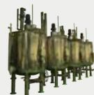
采用双层热水循环保温式结构能精确控制巧克力温度。带刮板的搅拌器能够提供足够的搅拌能力。
