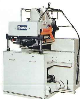
クラスター・チョコレート・デポジッタ Cluster chocolate depositor
